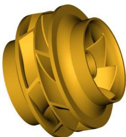
Лопасты с обеих сторон рабочего колеса расположены симметрично, что обеспечивает компенсацию гидравлических пульсаций. Осевые нагрузки сведены к минимуму.
